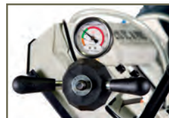
Manómetro tensión de hoja
